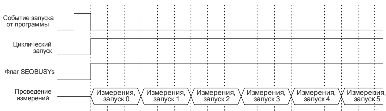
Рисунок 19.7 – Диаграммы работы секвенсора при циклическом запуске
