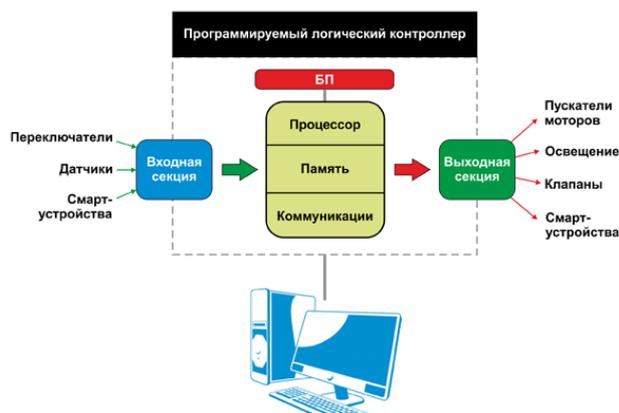
Рисунок 1: Состав и принцип действия пкп
