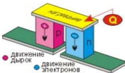
Рис. 2. Движение электронов и дырок в материале при нагреве
