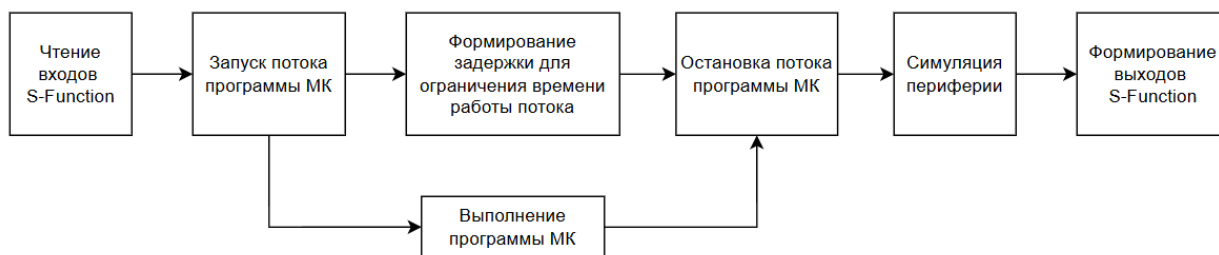
Рисунок 6 – Функциональная схема алгоритма управления выполнением программой МК
