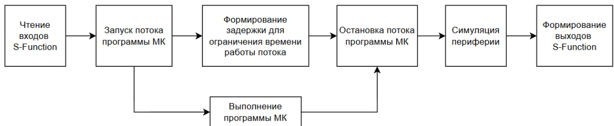
Рисунок 6 – Функциональная схема алгоритма управления выполнением программой МК
